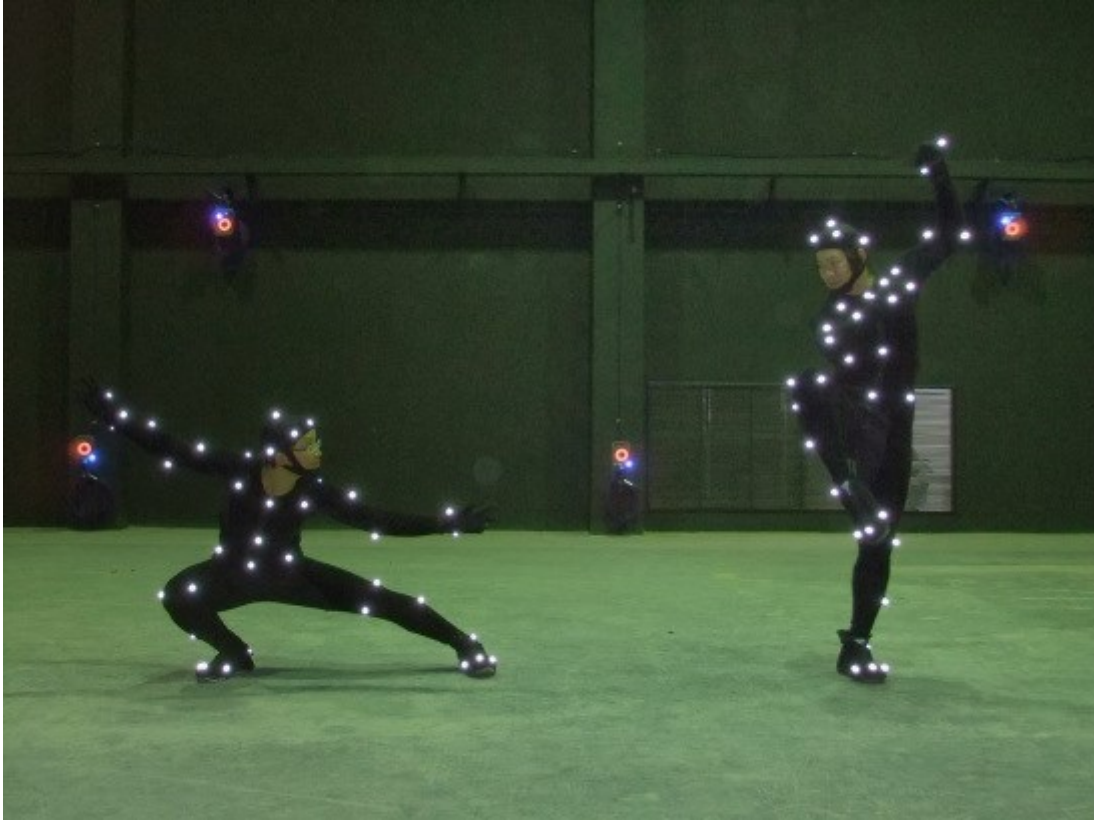
Kuva 18. Optisen liikkeenkaappauksen puvut (edessä) ja kamerat (takana) (Sentimental Flow, 2017).
