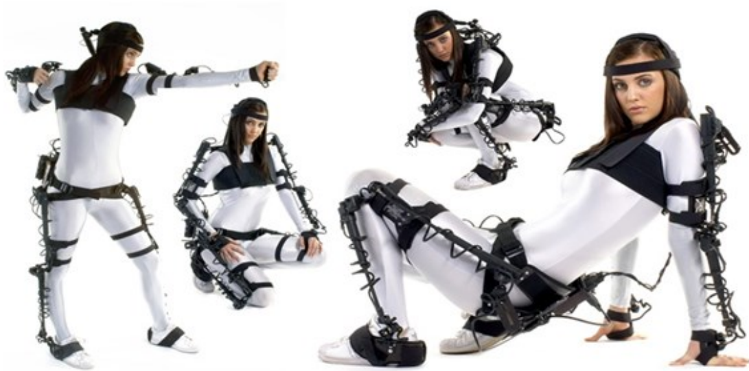
Kuva 20. Mekaaninen Gypsy-liikkeenkaappauspuku (Gmiterko ja Lipták, 2013).
