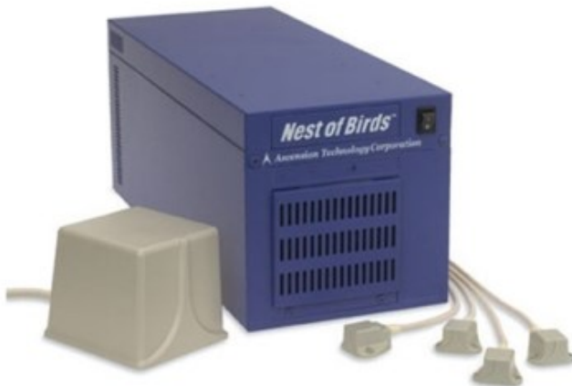
Kuva 19. Magneettinen liikkeenkaappauslaite Nest of Birds (Gmiterko ja Lipták, 2013).
