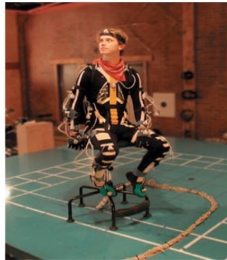
Kuva 19. Magneettinen liikkeenkaappauslaite Nest of Birds (Gmiterko ja Lipták, 2013).
