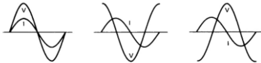
Kuva 2: Resistiivinen kuorma (vasemmalla), induktiivinen kuorma (keskellä) ja kapasitiivinen kuorma (oikealla). [11]
