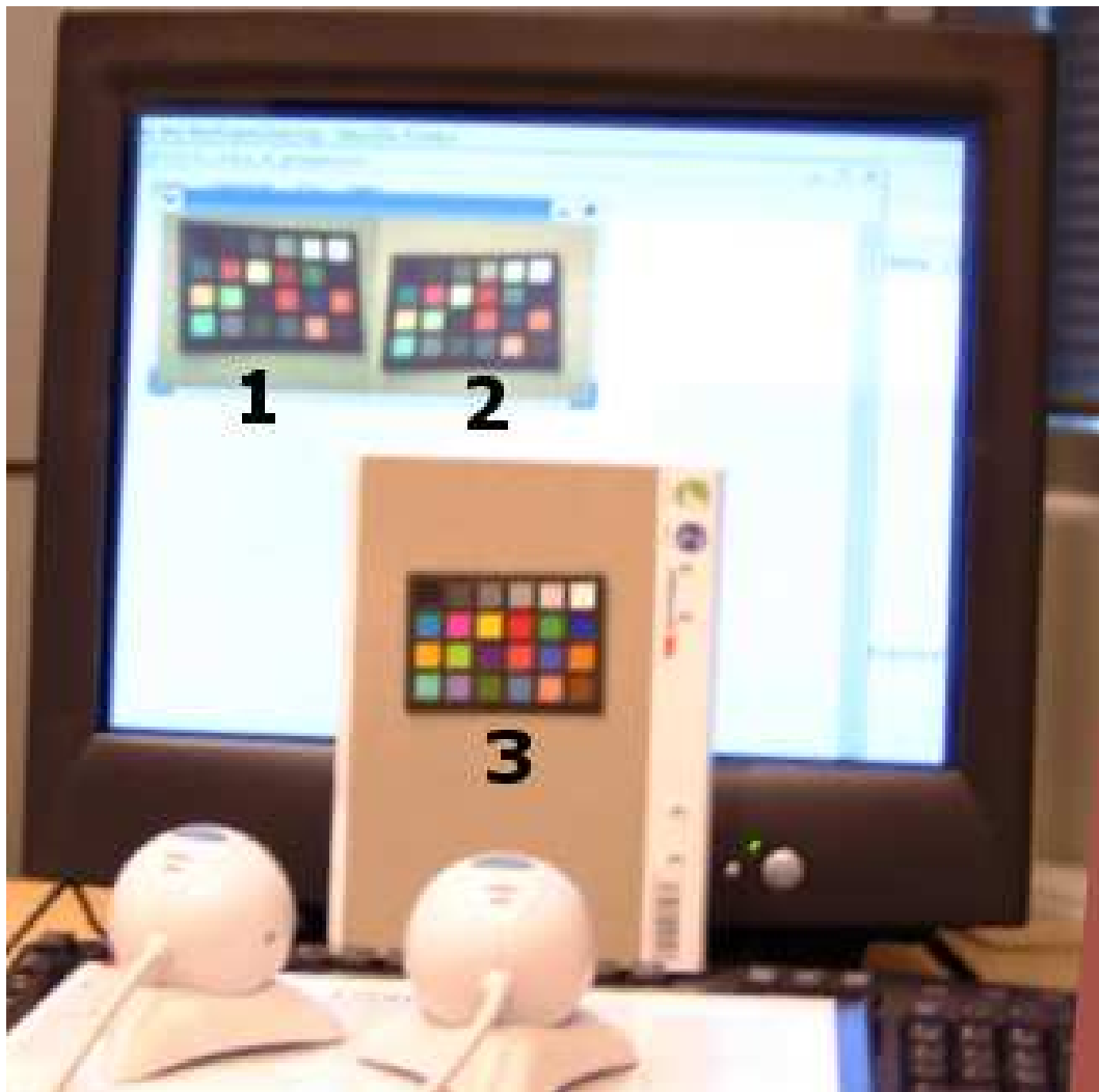
Kuva 20: Koejärjestely näyttölaitteen värikalibroinnin tulosten selvittämiseksi. Kamera 1 on vasemmalla ja kamera 2 oikealla.
