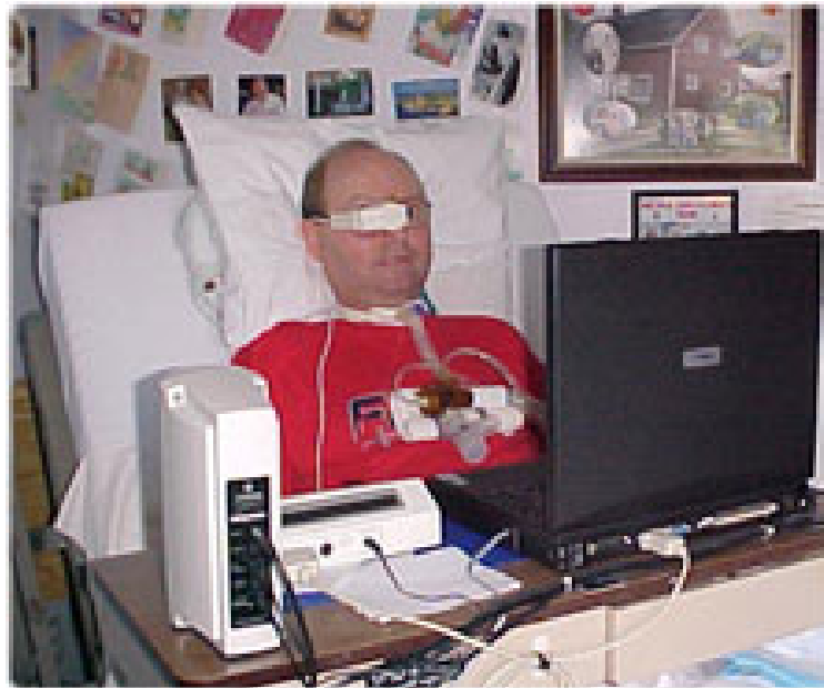
Kuva 28: Kannettavaan tietokoneeseen kytketty VisionKey –järjestelmä (H.K. EyeCan Ltd., 2007).
