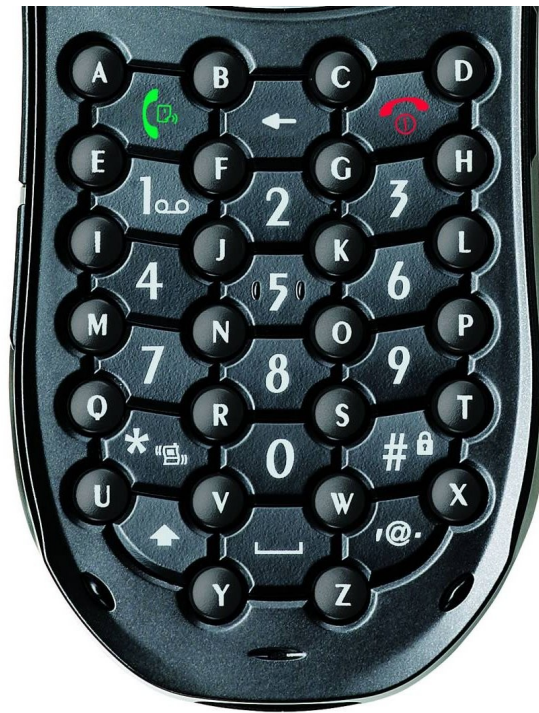
Kuva 5: Fastap-näppäimistö LG 490 -matkapuhelimessa. (Kuvaa käytetty Digitwireless:n luvalla.)
